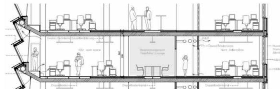
Obrázok 26 a Obrázok 27 Priznané železobetónové dosky ako akumulačná hmota, ENERGYbase, POS architektken Figure 26 and Figure 27 Uncovered reinforced concrete slabs as a mass capable of storage, ENERGYbase, POS architektken
