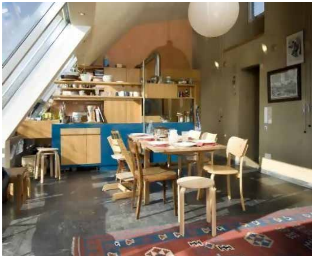
Obrázok 31 Vysoko kumulčný kameň na podlahe, hlinená omietka 2-vrstvová na strope ako akumulčná hmota, Plne ekologická strešná nadstavba, POS architekten Figure 31 High storage soapstone on the floor, clay plaster 2-layer on the ceiling as a storage mass, Fully ecological roof extension, POS architekten
